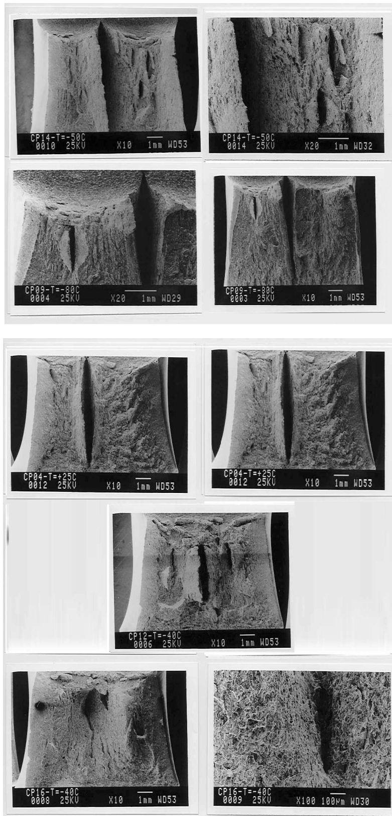
Figura 4 – Superfícies de fratura apresentando splits
